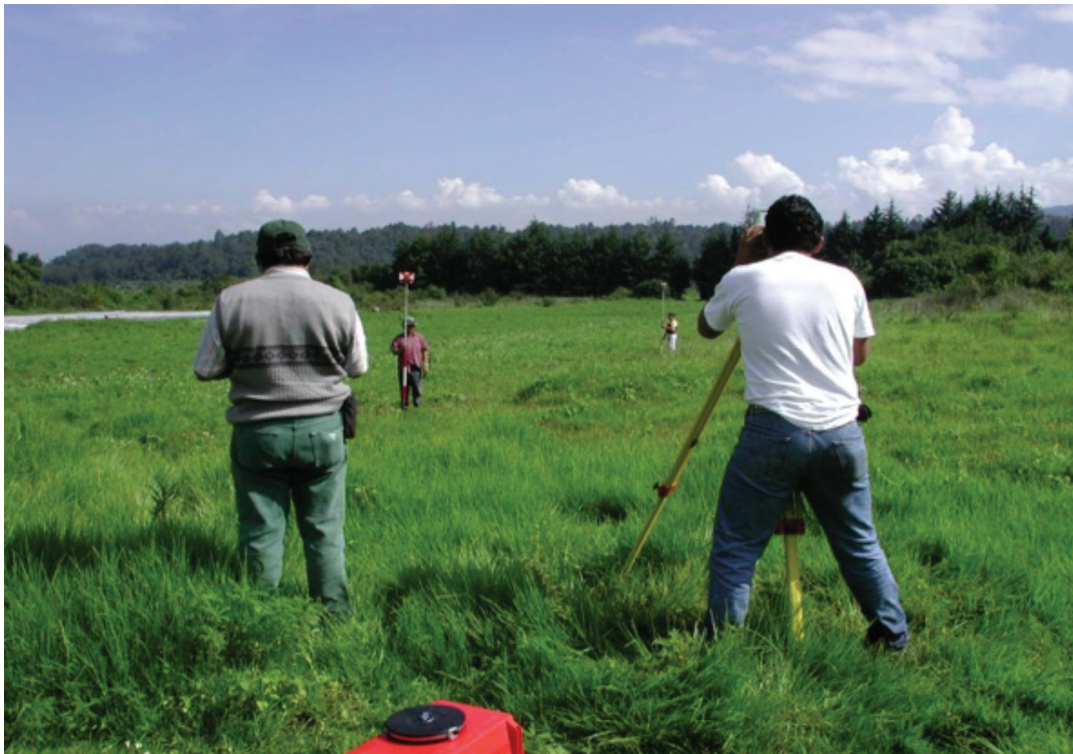
Fotografía 8. Obtención de la curva de nivel en el terreno con estación total.
