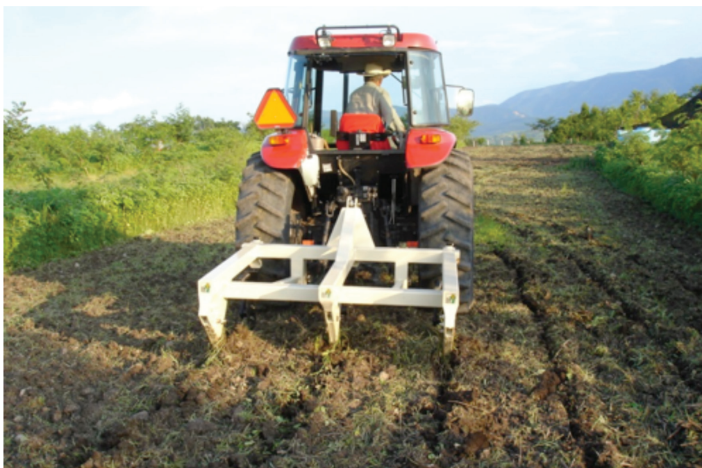
Fotografía 36. Operación de arado mexicano para el método de la Línea Clave.
