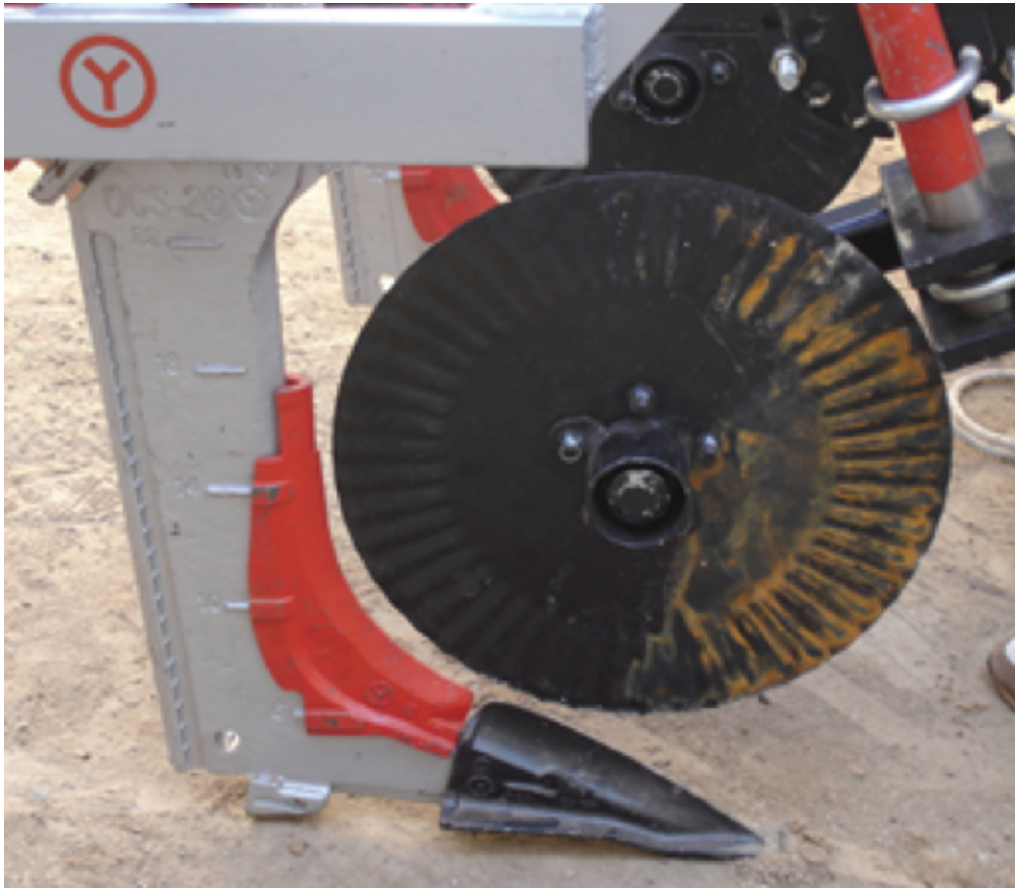
Fotografía 32. Arado Yeomans con “espinillera”, “zapatilla” y disco abridor.
