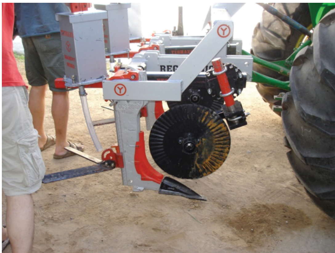
Fotografía 28. El arado Yeomans con disco abridor y sembradora.
