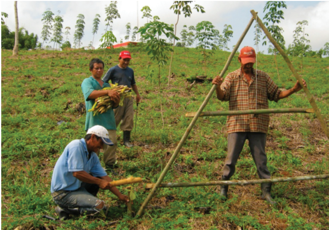
Fotografía 7. Obtención de la curva de nivel en el terreno con el nivel "A".
