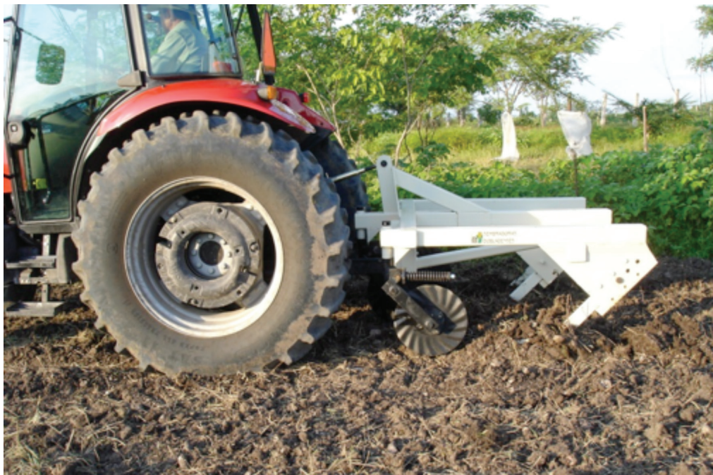
Fotografía 35. Arado “Dobladense” surcando con el método de la Línea Clave.
