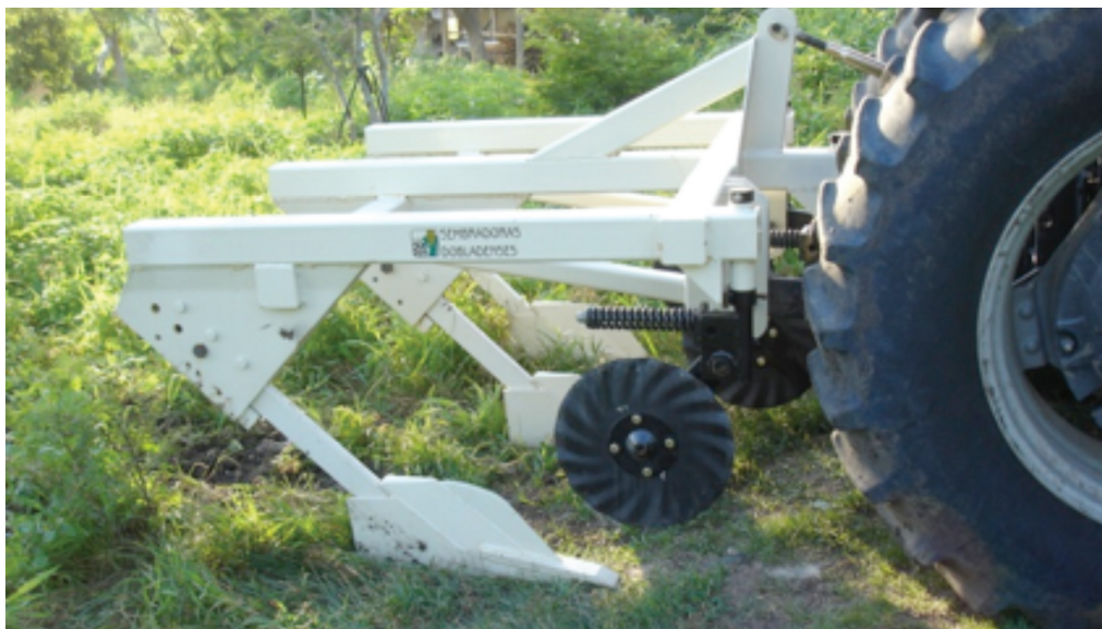
Fotografía 34. Arado “Dobladense” para el método de la Línea Clave.
