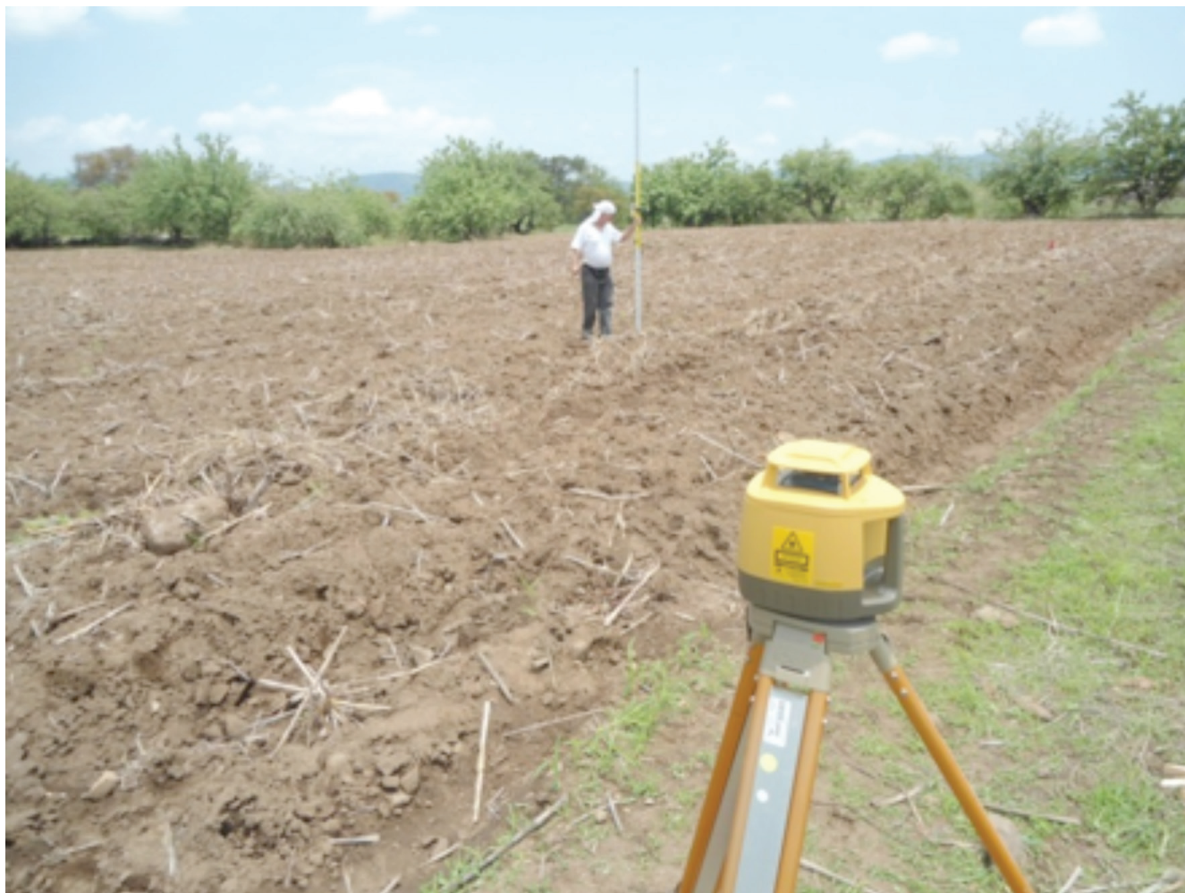
Fotografía 9. Obtención de la curva de nivel en el Punto Clave con nivel láser.
