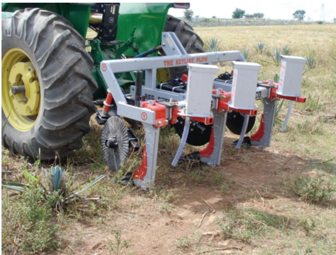
Fotografía 29. Otra vista del arado Yeomans con disco abridor y sembradora.
