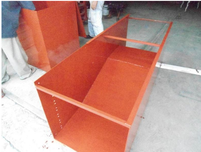
La canaleta de aforo terminada
