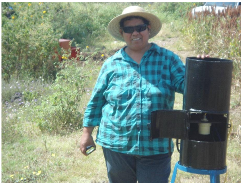
Figura 33. El prototipo de pluviógrafo terminado
