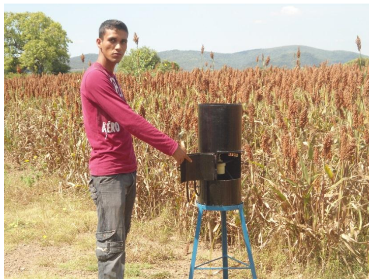
El pluviógrafo ya instalado en campo
