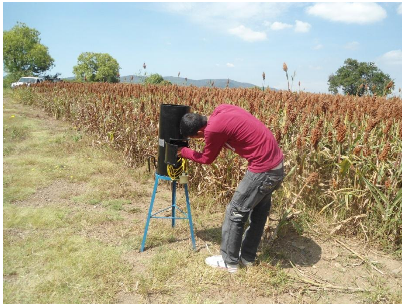
Instalando el pluviógrafo en campo
