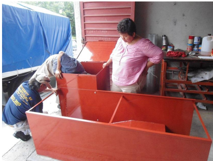
Ensamblando canaleta aforadora con caja de amortiguación
