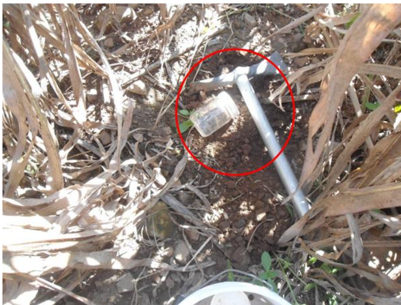
Fotografía 14. Muestreo de suelo para medir contenido de humedad.
