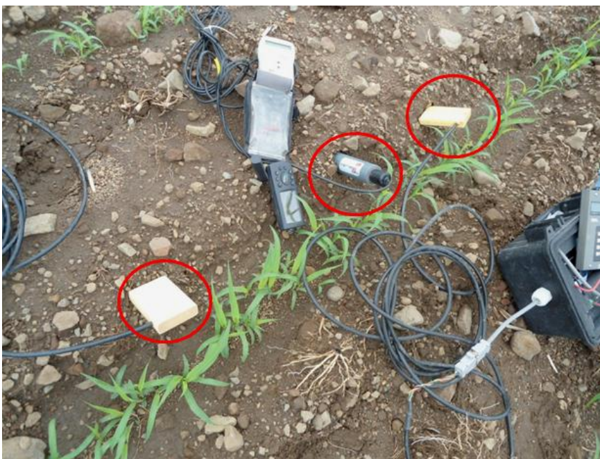
Fotografía 13. Monitoreo de humedad del suelo con equipo TDR.
