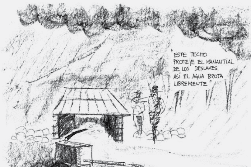
Este techo protege el manantial de los deslaves. Así el agua brota libremente.
