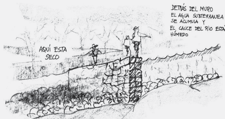
Detrás del muro el agua subterránea se acumula y el cauce del río está húmedo.
