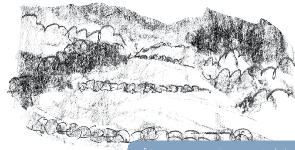
Diques de piedras en serie en una quebrada de poca pendiente.
