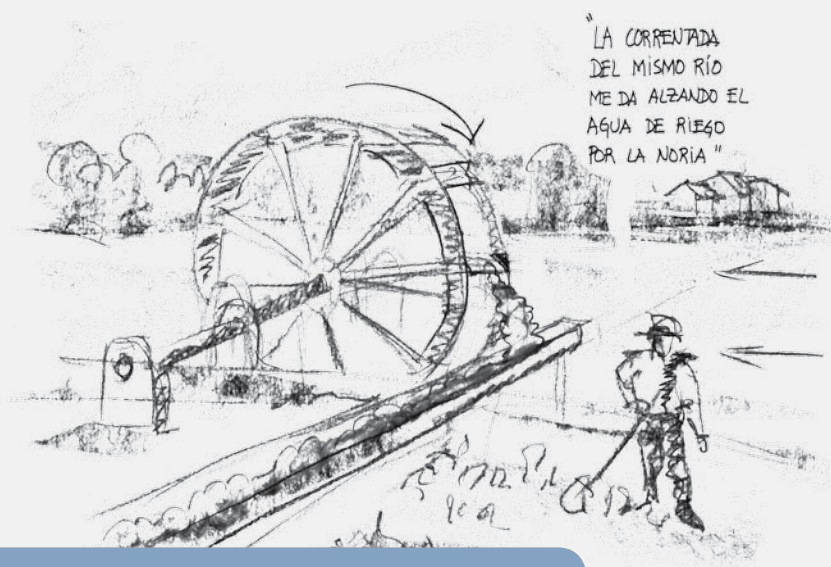
La correntada del mismo río me da alzando el agua de riego por la noria.
