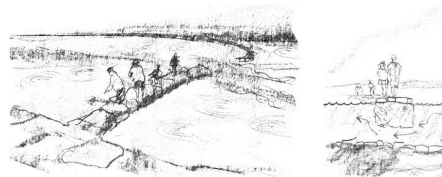
IZQ: Dique completado. DER: Sección del dique.
