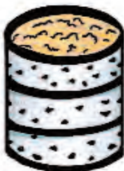
Tacho de 200 litros sin tapa ni fondo con agujeros en toda la superficie
